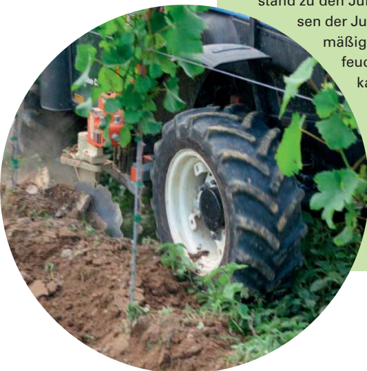
Bild 4: In Junganlagen ist die Pflege des Unterstockbereichs (hier mit Scheibenpflug im 7 km/h schnellen Einsatz) besonders wichtig Bild: M. Erhardt
